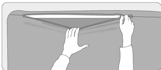
Para ajustar el gráfico de tela (no suministrado) a la estructura, basta con envolver el marco de aluminio de abajo hacia arriba o de izquierda a derecha (según el modelo) y luego cerrar cuidadosamente la cremallera trasera.
